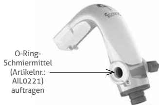
Abbildung 11. O-Ring an der Halterung schmieren
