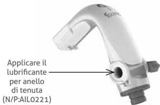
Figura 11. Anello di tenuta per adattatore di isolamento dentale Isovac(tm) da lubrificare
